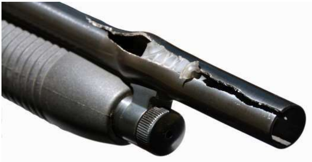
Fucile calibro 12. Il picco delle pressioni, dovuto a ostruzione, ha causato rigonfiamento e fessurazione della canna in prossimità della volata
