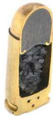
Una cartuccia metallica sezionata. Si nota all'interno la polvere da sparo e la palla blindata con il nucleo di piombo
